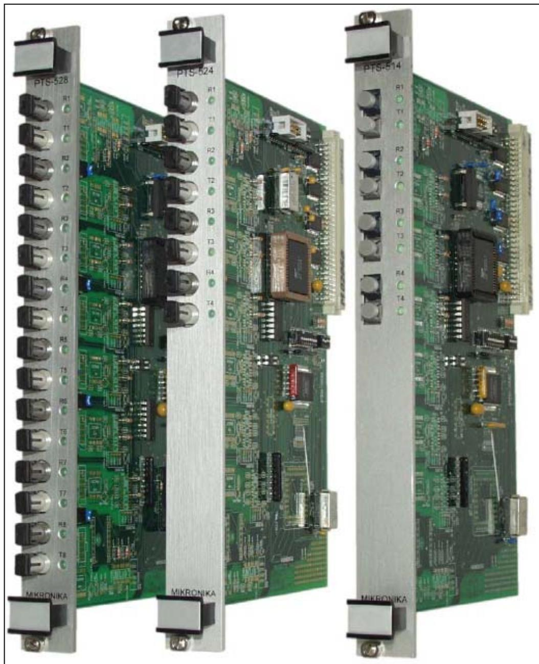
Рисунок 3. Внешний вид модулей PTS-528, PTS-524, PTS-514.
