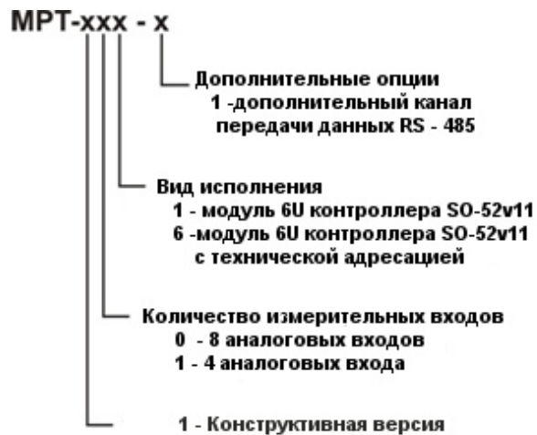
Рисунок 3. Схема выбора и обозначения модуля МРТ-1ХХ.
